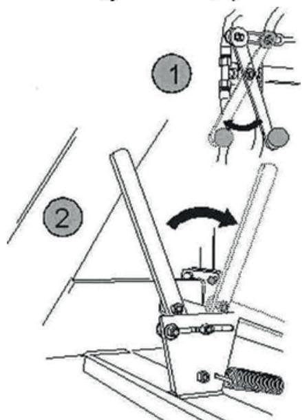
Avant de raccorder le tracteur à l'arrière de la machine, déclavetez l'engrenage et soulevez l'attelage à l'avant, avant de mettre la machine en route.
