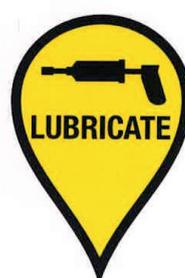
**LUBRIFIER** Signale une action nécessaire telle que décrite dans la description d'entretien de la machine.
