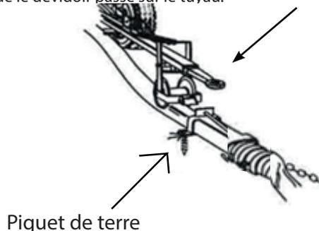
Déroulez la machine en appliquant suffisamment de force sur le frein, de manière à toujours maintenir le tuyau bien tendu avec le frein électrique sur l'enrouleur.
