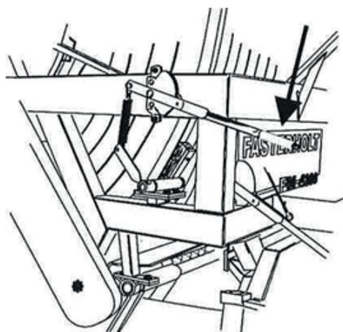
Après l'irrigation, serrez le frein et desserrez la courroie. Ensuite, ouvrez la vanne de dérivation (levier « 1 » poussé vers l'intérieur), afin que la boîte d'engrenage soit désengagée (levier « 2 » tiré vers l'extérieur). Si l'attelage arrière est tendu, tournez l'essieu primaire avec une clé plate afin de désengager le coupleur.
