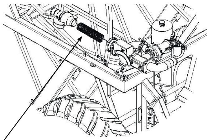
Nettoyez le filtre de sortie de la turbine si besoin. Vérifiez la bonne disposition du tuyau.
