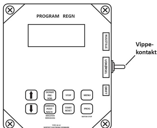
Pendant le déroulement de la machine, l'INTERRUPTEUR À BASCULE doit être basculé sur la position médiane (déroulement) afin qu'elle ne se réinitialise pas en chemin. Après le déroulement, basculez l'INTERRUPTEUR À BASCULE vers le bas (marche).
