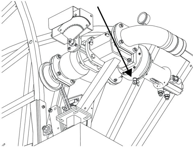
Sur les machines avec un bouton d'arrêt de haute pression, appuyez sur START (DÉMARRER) pour ouvrir la vanne principale et laisser l'eau couler librement. (Débranchez le câble de la batterie pour que la vanne d'arrêt ne se referme pas à nouveau.)
